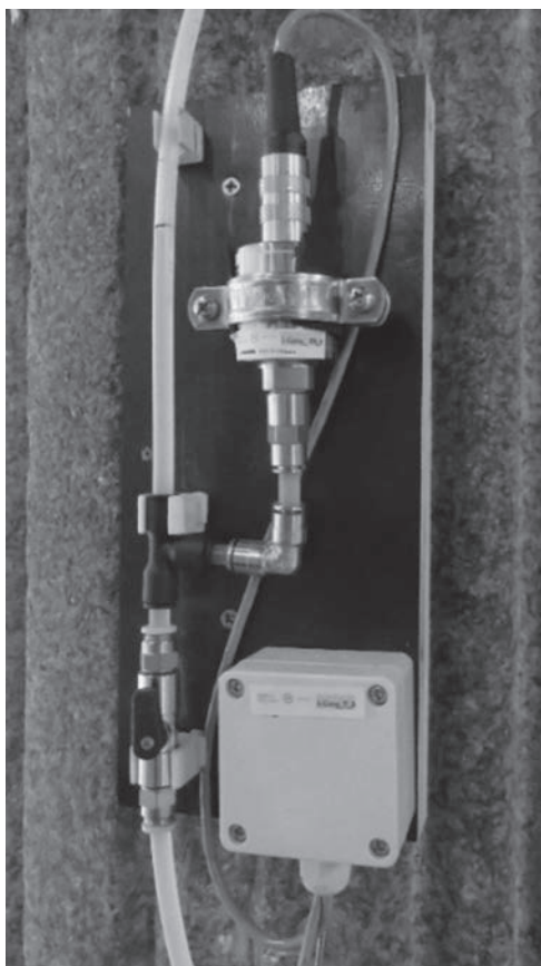
Fig. 28. Igreja dos Congregados - Sensores de nível instalados e em funcionamento no Nivel 0, nas Zona 1 e 0: (a) junto à fachada; (b) numa das colunas de suporte do coro-alto;
