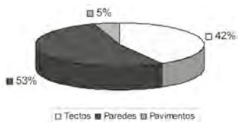
Fissuras nos quartos.
