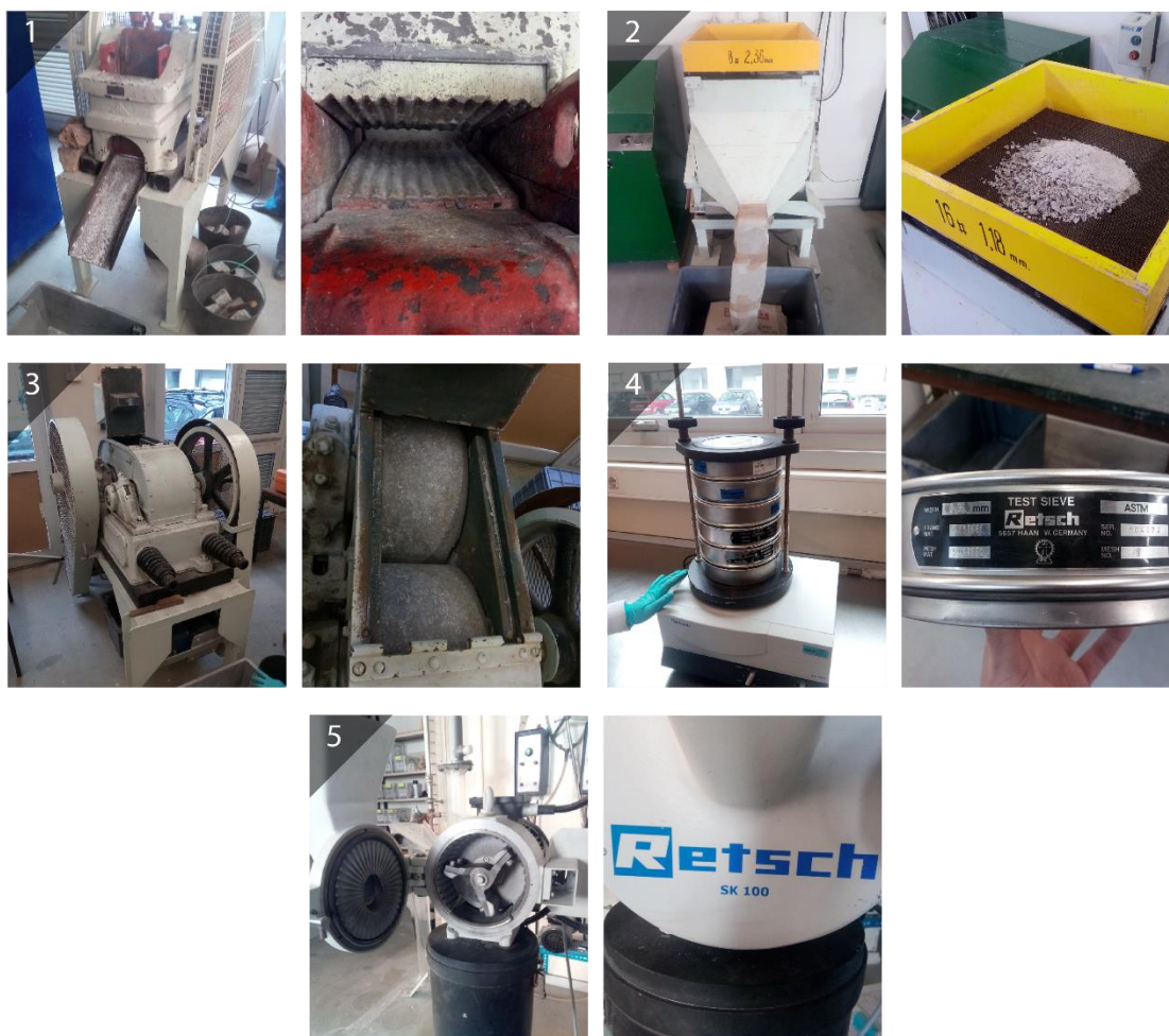
Figura 27 – Equipamento para obtenção de resíduos com granulometria definida: (1) britador de maxilas, (2) crivo de calibres grosseiros, (3) moinho de rolos, (4) crivo de calibres finos e (5) moinho de martelos.
