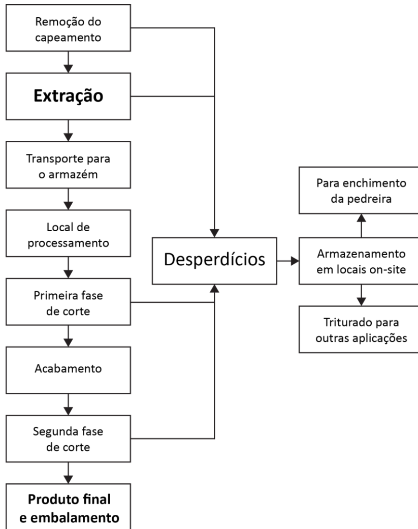
Figura 5 - Diagrama do processo de extração de rocha natural (University of Tennessee e Center for Clean Products 2008).
