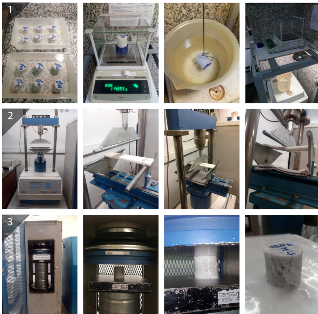
Figura 29 – Ensaio físico-mecânicos efetuados aos provetes normalizados: (1) ensaio de absorção de água e massa volúmica aparente, (2) ensaio de flexão e (3) ensaio de compressão.
