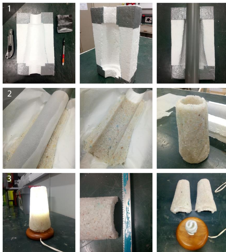
Figura 40 – Construção do protótipo: (1) obtenção do molde, (2) vazamento no molde coberto por papel vegetal e (3) teste e retificação das peças obtidas.
