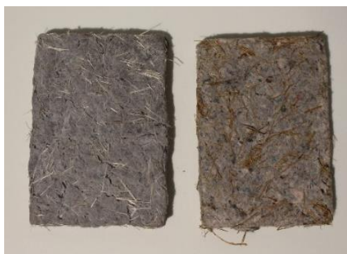
Figura 34-Amostra de pasta de papel e fibra de sisal (esquerda) e amostra de pasta de papel e fibra de coco (direita)
