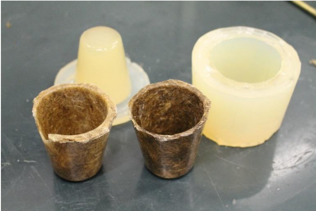
Figura 31- Duas peças realizadas com PLA e fibra de sisal
