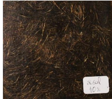
Figura 39- Amostra de PLA com 10% de fibra de sisal
