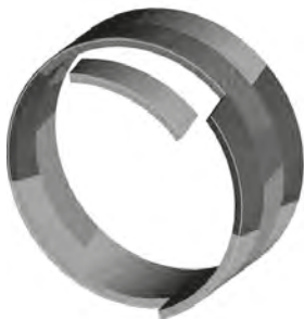
Aduelas de um anel Imagem gerada pelo software de escolha de posição dos anéis para o traçado pretendido - ordem de montagem
