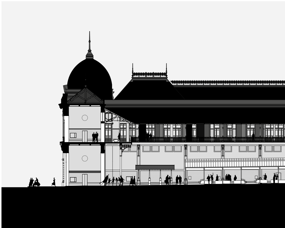
Fig. 42. Alçado interior do Mercado, ilustrando a área de reintegração das barracas históricas (2015).
