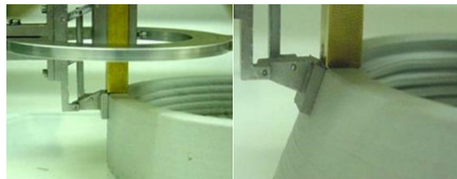
Figura 2.26 - Impressão de parede ortogonal e oblíqua, respetivamente, mostrando a versatilidade dada pela espátula no momento de impressão (Fabbaloo 2014).
