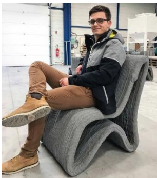
Figura 2.90 - Cadeira urbana, 80x70x60 cm, 110 kg, camadas com a altura de 15 mm, impresso em 14 minutos (Construtions-3D 2018b).
