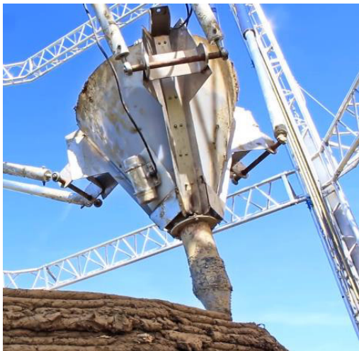
Figura 2.65 - Extrusor da impressora Delta Big 66 (WASP 2017a).
