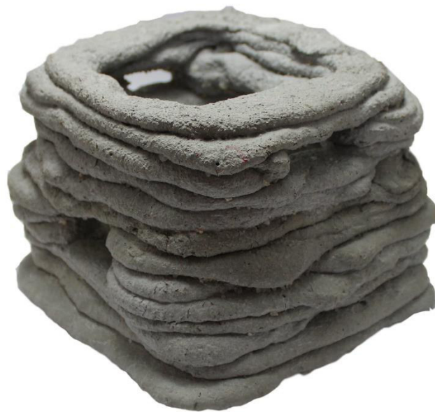
Figura 4.14 – Peça impressa, aproximadamente com as dimensões de 145x142x105 mm 3 .
