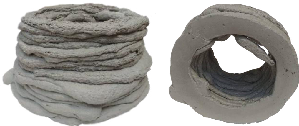
Figura 4.9 - Pormenor que demonstra a queda de uma camada durante o processo de impressão.
