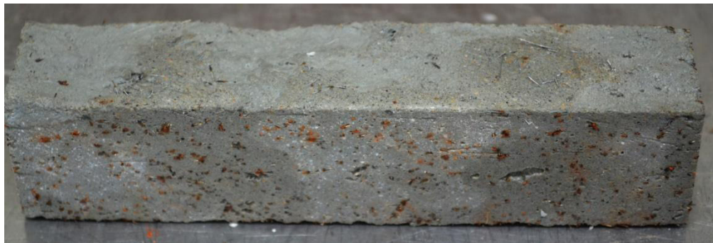
Figura 3.34 – Proвете impresso para ensaios mecânicos, com fibras de 6mm, depois do corte das laterais.
