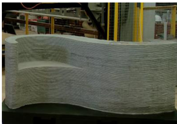
Figura 2.29 - Elemento impresso pela Universidade de Loughborough (concreteprinting 2010).
