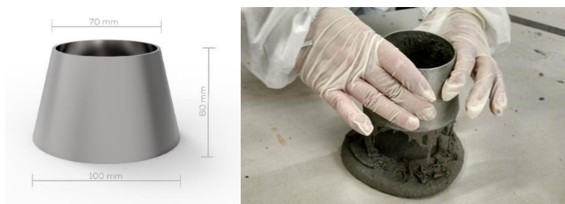
Figura 3. Molde tronco-cônico utilizado no ensaio de espalhamento.
