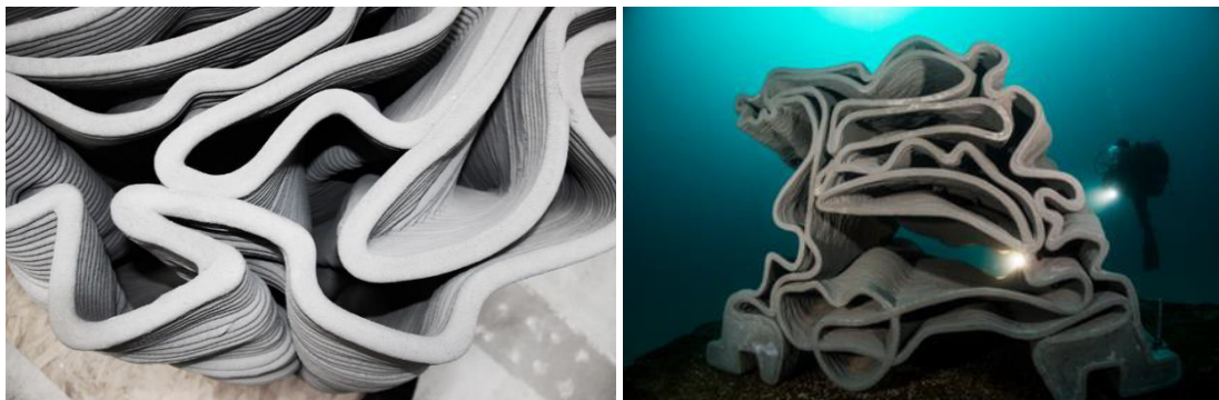
Figura 2.59 - Recife artificial impresso pela tecnologia de impressão 3D em betão da XtreeE (XtreeE | the large scale 3D 2017) .
