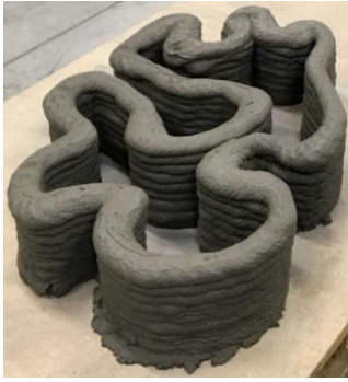
Figura 2.88 - Recife, 80x70x60 cm, 250 kg, camadas de 20 mm de altura impressa em 32 min (Construtions-3D 2018b).
