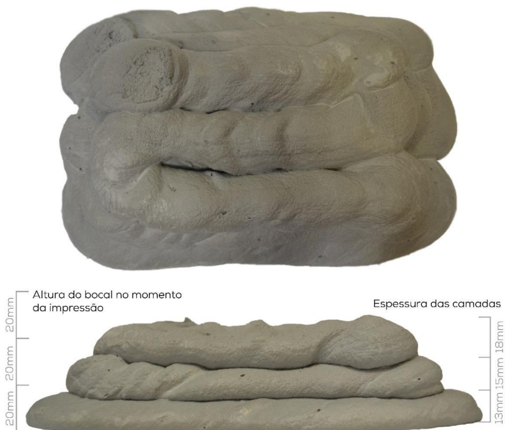
Figura 4.1 – Peça impressa com sobreposição de camadas.
