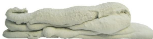
Figura 3.14 – Testes de impressão com seringa de pastelaria, exemplar 2.
