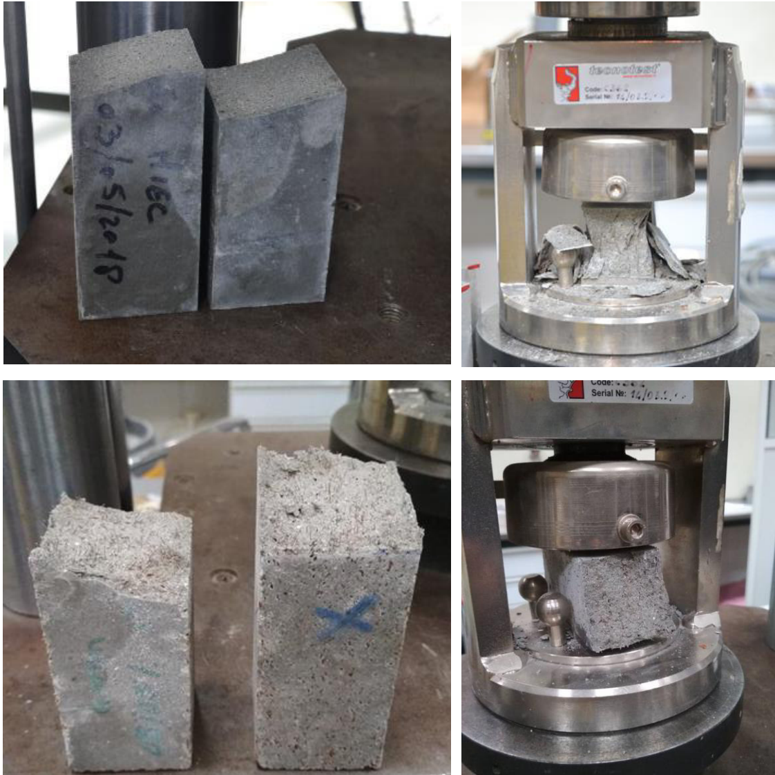
Figura 3.37 – Provetes durante ensaios à compressão argamassa A e argamassa C, respetivamente.
