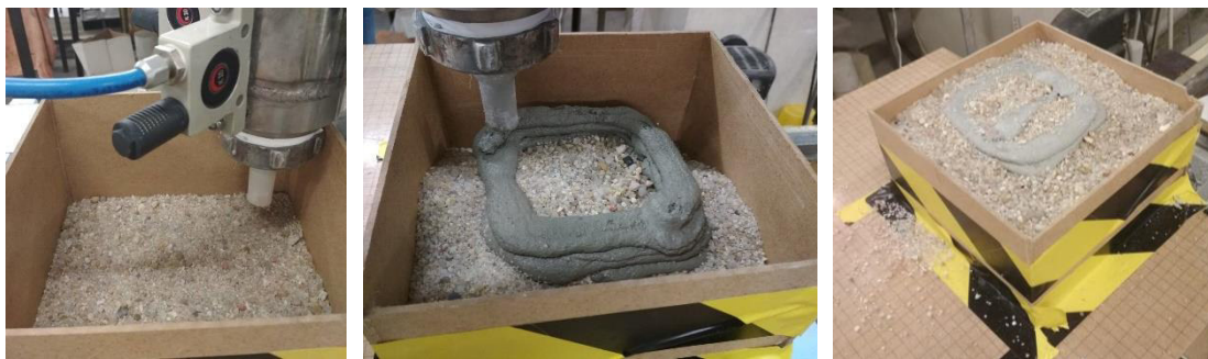
Figura 4.12 – Processo de impressão com areia, como material de suporte.
