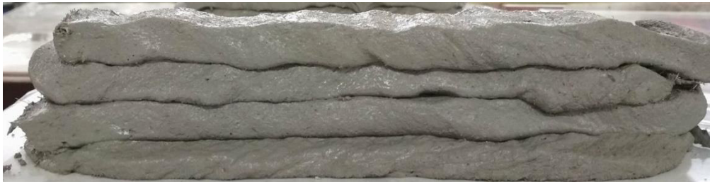
Figura 3.33 – Proвете impresso para ensaios mecânicos, com fibras de 6mm.
