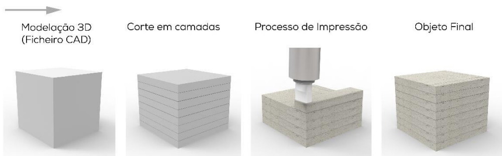
Figura 2.5 - Etapas fundamentais durante um processo de fabricação aditiva (adaptado de khorram niaki e Nonino 2015).
