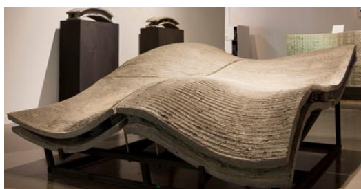
Figura 2.30 - Elemento arquitetónico impresso pela Universidade de Loughborough (Loughborough University 2018; Lim et al. 2011).
