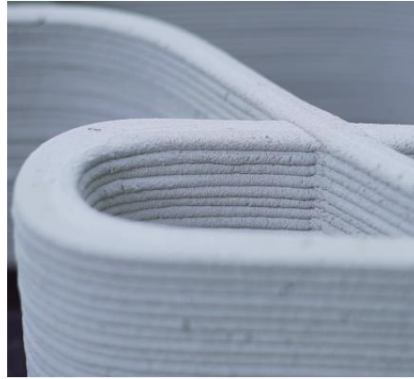
Figura 2.61 - Pormenor que demonstra a alta resolução de impressão da tecnologia Bruil (Bruil 2017).
