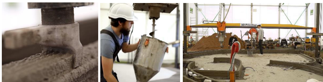
Figura 2.92 - Pormenor do bocal com aresta dentada (Printhuset 2017a), extrusor com parafuso de Arquimedes, da impressora BOD2-483 (Printhuset, 2017b), imagem da impressora BOD2 em processo de impressão (Printhuset, 2017a).
