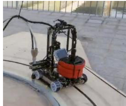
Figura 2.35 - Robô "Base Robot" durante processo de impressão, com as dimensões de 270x300x120 mm (Stereotactil, 2015).
