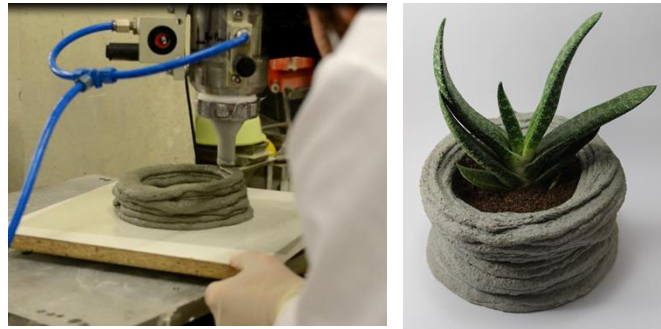
Figura 9. Processo de impressão do vaso com a argamassa B e contexto funcional, respetivamente.
