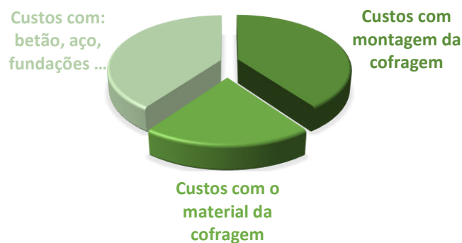
Figura 2.13 - Gráfico com a repartição de custos de uma construção em betão (adaptado de Nemati 2007).
