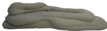
Figura 3.13 – Testes de impressão com seringa de pastelaria, exemplar 1.
