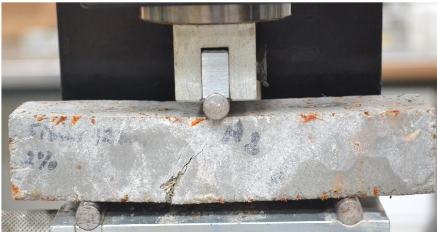
Figura 3.36 – Ensaio à flexão em provete impresso com fibras metálicas de 13mm.
