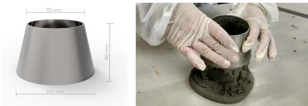
Figura 3.16 – Molde metálico tronco-cônico utilizado no ensaio de espalhamento.
