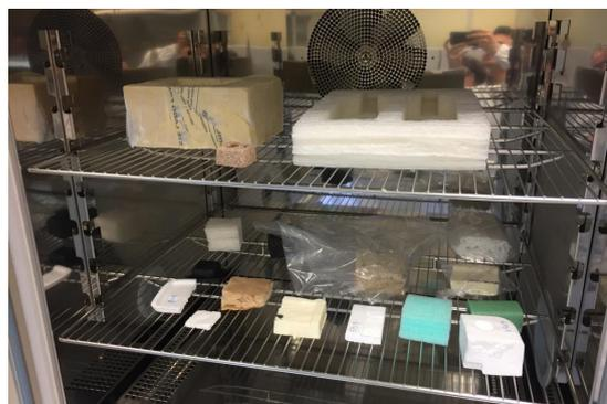
Fig. 115. Materiais na câmara climática antes de se iniciar o teste de condicionamento atmosférico.
