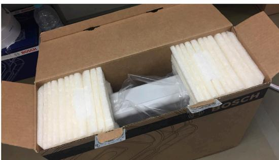
Figs. 202-203. Caixa e insertos após teste de compressão
