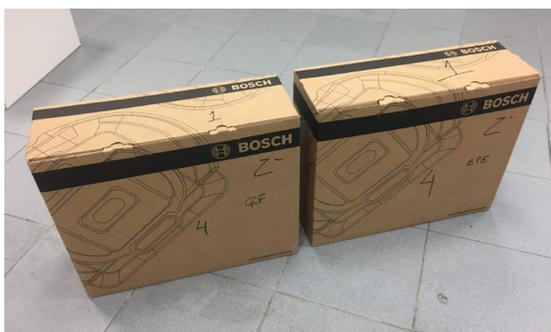
Fig. 219. Marcação das caixas, numerando e assinalando as faces, as arestas e o canto para queda.
