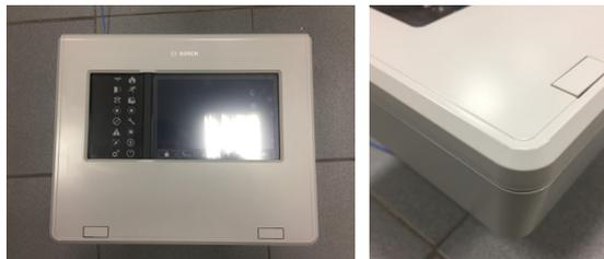
Figs. 256-257. Produto sem marcas ou danos depois do teste de queda
