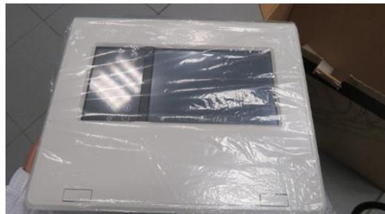
Figs. 217-218. Inserção (EPE) e produto depois do teste de vibração vertical
