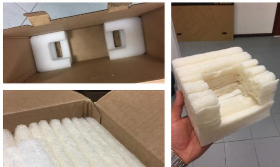
Figs. 253-255. Inserts (EPE e GCF) depois do teste de queda - deformações aceitáveis
