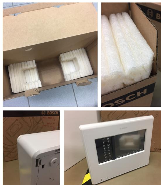
Figs. 212-215. Caixa, insertos (GCF) e produto depois do teste de vibração vertical
