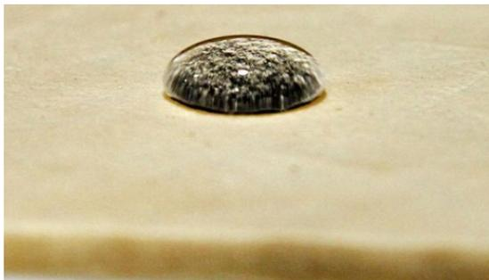
Fig. 48. Myco Flex™, impermeabilidade.
