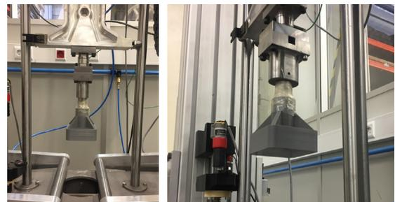
Figs. 121-122. Aplicação do novo batente na máquina de impacto
