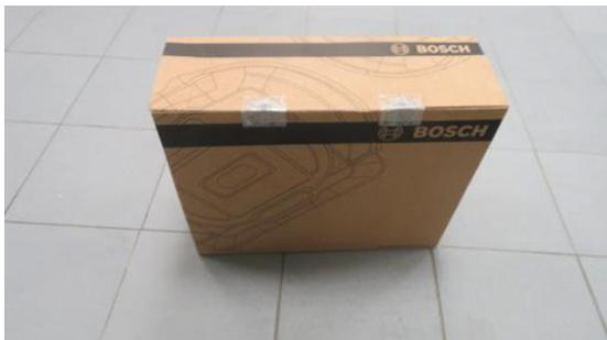
Fig. 216. Caixa exterior de cartão depois do teste de vibração vertical
