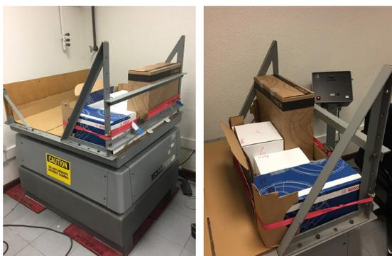
Figs. 210-211. Embalagem durante o teste de vibração
