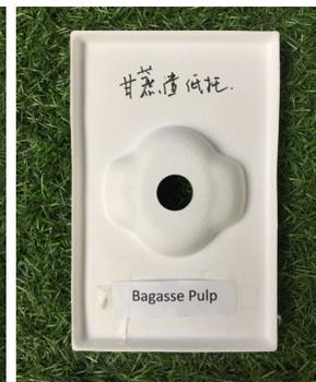
Figs. 94-95. Amostra de inserto em polpa de bagaço
