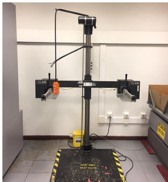
Fig. 108. Equipamento utilizado para libertar a embalagem
