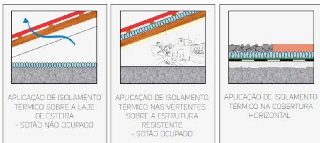
Fig. 24 Estratégias de colocação de isolamento nas coberturas [11]
