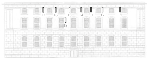
Fig. 55 Localização dos tirantes metálicos no alçado da fachada lateral direita.
