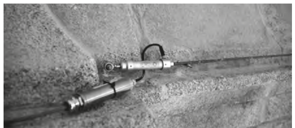
Fig. 62 Fotos ilustrativas do tipo de instrumentação instalada: a) extensómetros e RTDs nos tirantes metálicos, b) fissurómetro numa junta de blocos de pedra, c) sensor de rotações (clinómetro, à esquerda) e temperatura (à direita), d) sensor de deslocamento, e) sensor de temperatura e clinómetro com sentidos de medição da rotação e f) fissurómetro
