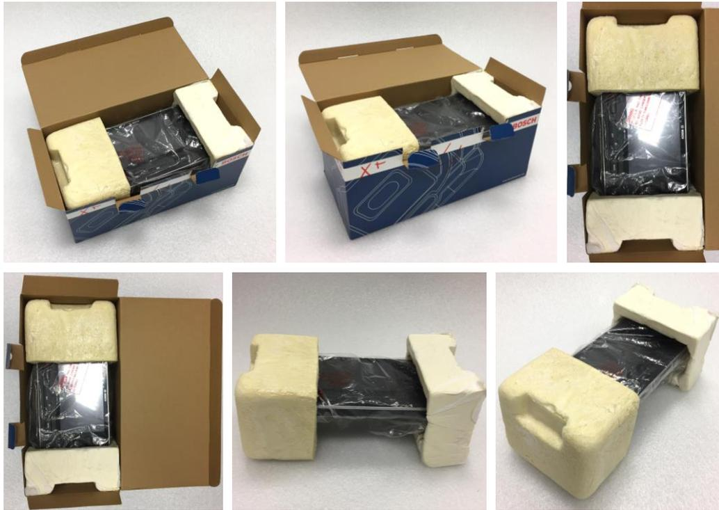
Figura 148: Inserto do primeiro desenvolvimento Vs. Inserto do segundo desenvolvimento.
