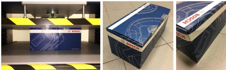
**Figura 113:** Embalagem durante o teste de compressão e embalagem após o teste, onde apenas se verifica uma dobra ligeira numa única lateral.
