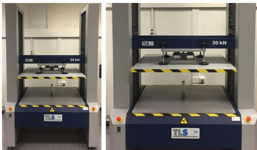
Figura 23: Equipamento utilizado na empresa Bosch para a realização dos testes de compressão.
