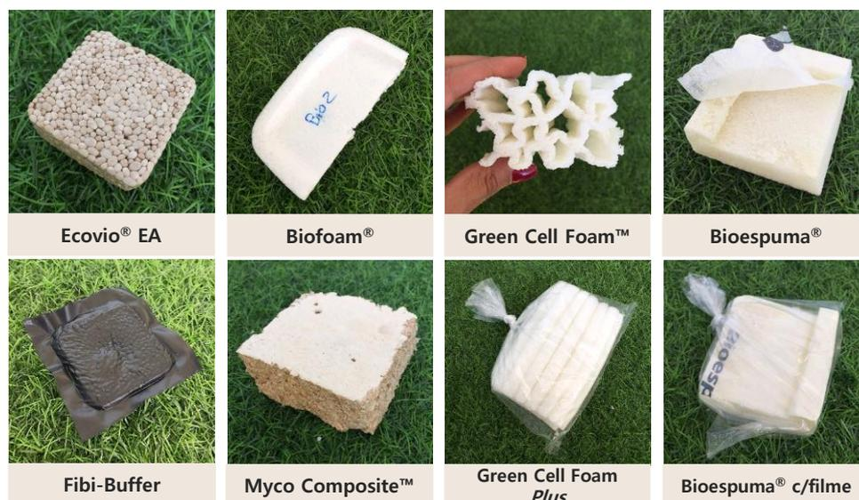
Figura 57: Amostras dos materiais após as três fases do teste climático.
