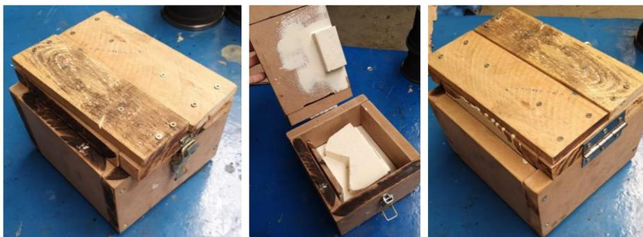
Figura 110: Moldes de madeira produzidos pelo fornecedor Kehl para a realização do primeiro protótipo.
