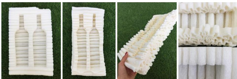
Figura 56: Green Cell Foam – antes e depois da primeira fase do teste climático.
