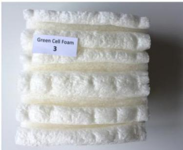
Figura 74: Amostra de GCF 3 após teste climático.
