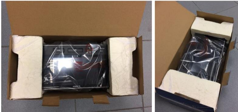
Figura 114: Insertos e produto idesk sem qualquer alteração após o teste de compressão.
