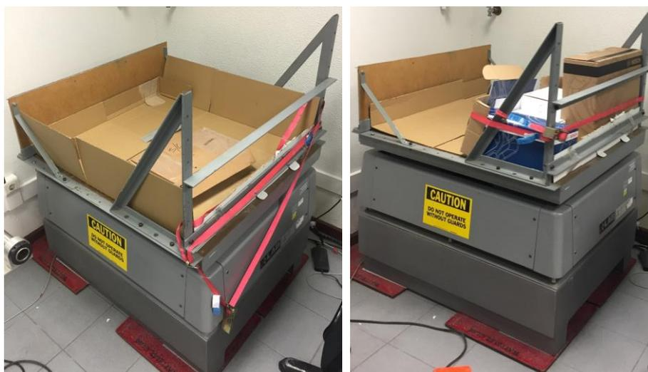
Figura 24: Equipamento utilizado na empresa Bosch para a realização dos testes de vibração.
