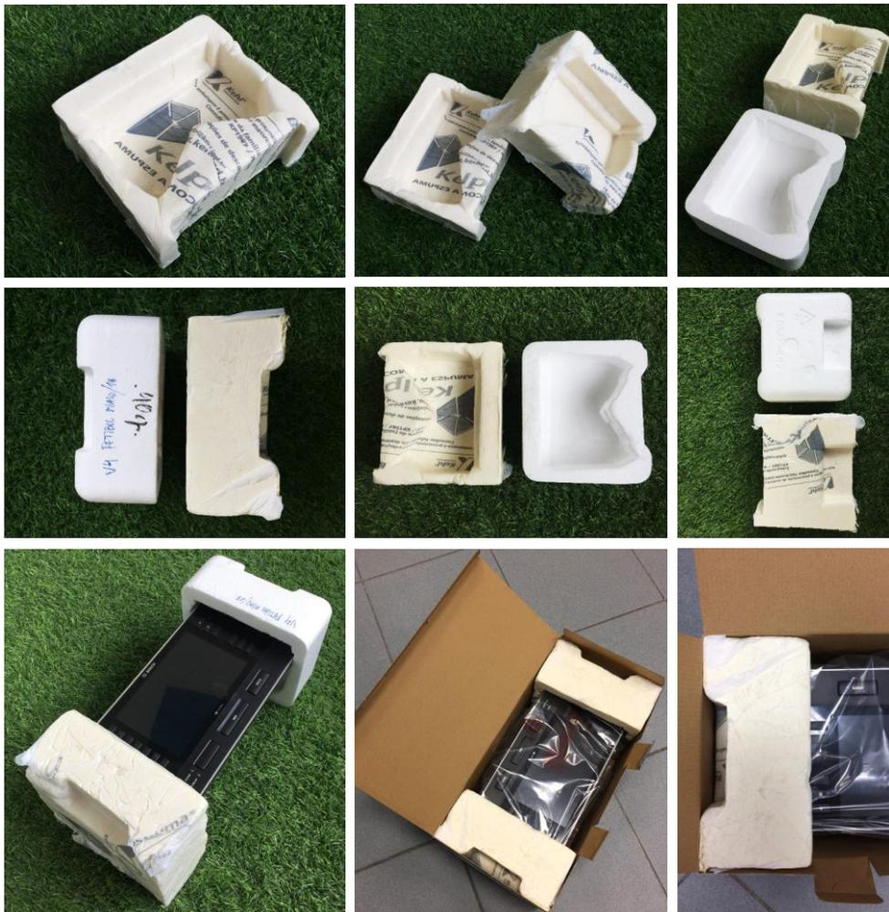
Figura 111: Primeiros protótipos desenvolvidos em Bioespuma e comparação com os insertos em EPS.
