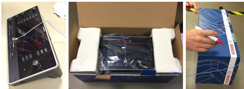
Figura 117: Preparação da embalagem em Bioespuma para o teste de queda livre.
