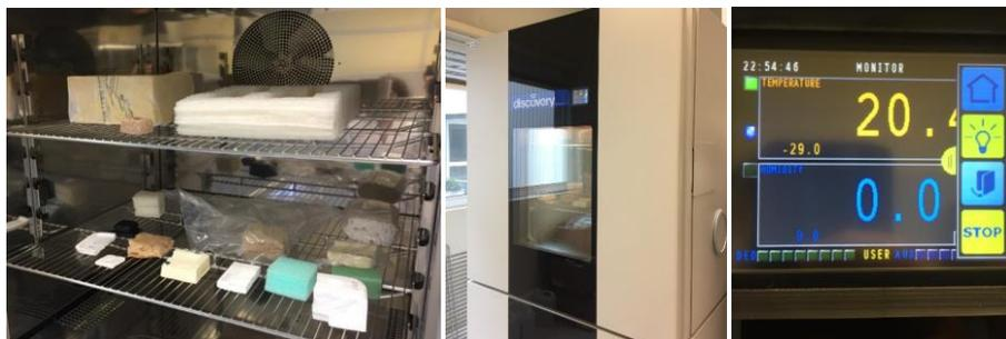
Figura 55: Colocação dos materiais na câmara climática e ajuste da temperatura e humidade.
