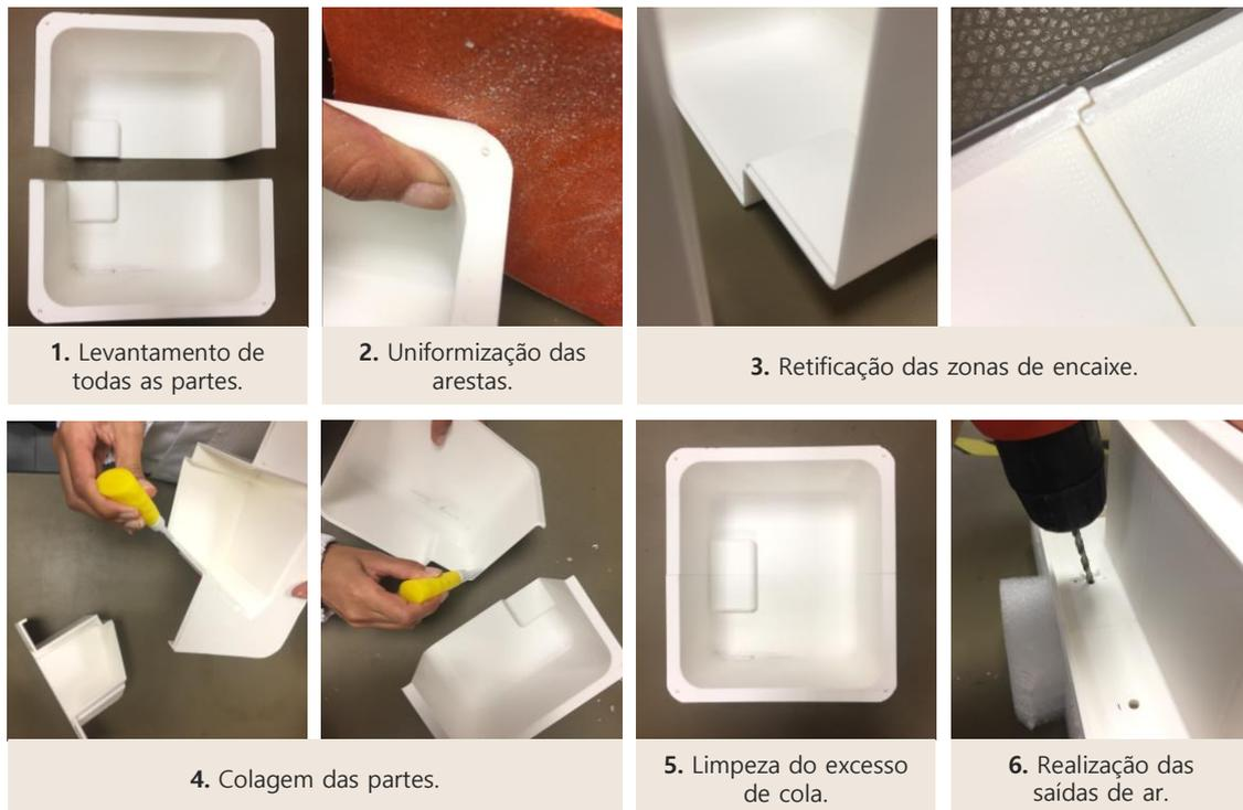
Figura 146: Processo de preparação do molde obtido por impressão 3D.
