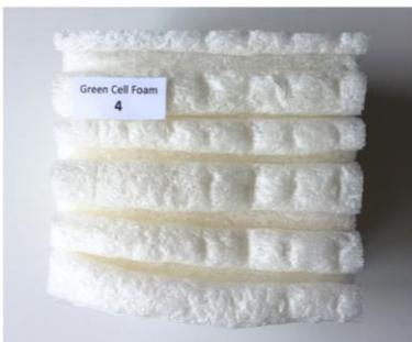
Figura 76: Amostra de GCF 4 após teste climático.
