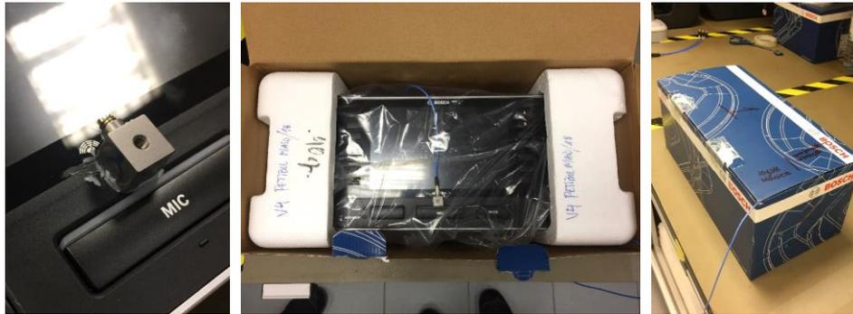
Figura 118: Preparação da embalagem em EPS para o teste de queda livre.
