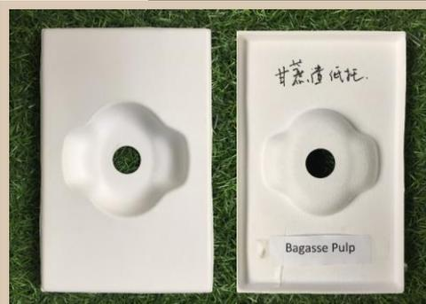
Figura 48: Polpa de Bagaço, amostra Bosch.
