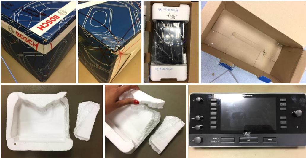
Figura 141: Embalagem, insertos e produto após teste de queda concluído – EPS.
