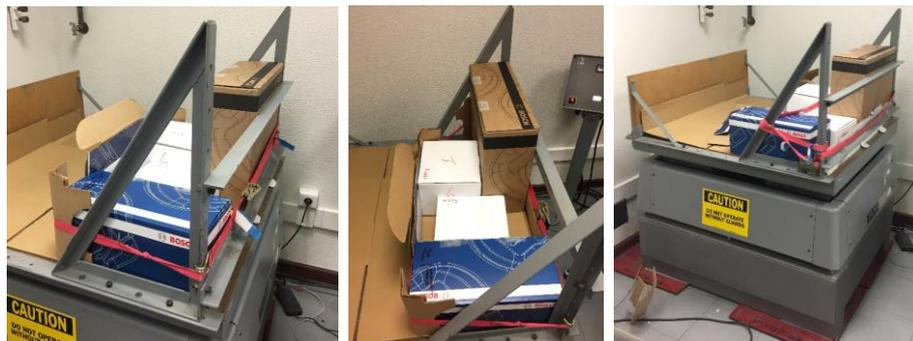
Figura 115: Embalagem em Bioespuma Kehl fixa na mesa vibratória.
