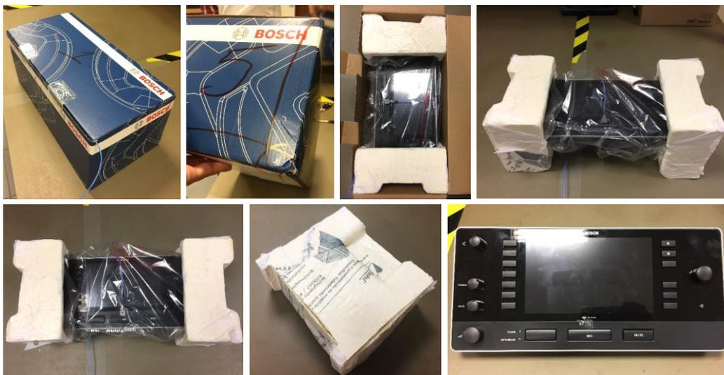
Figura 140: Embalagem, insertos e produto após teste de queda concluído – Bioespuma Kehl.
