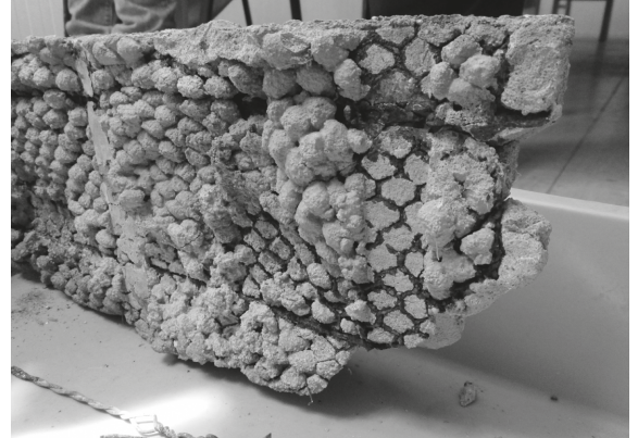
Fig. 04. Mísula original do TNSJ e processo construtivo em volume oco com rede de galinheiro, varões metálicos e réguas de madeira, 2015
