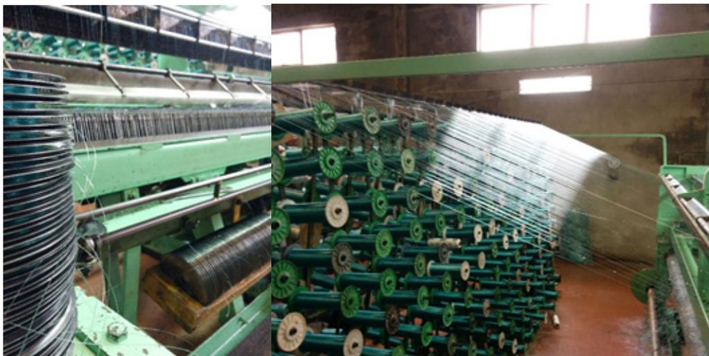
Figura 37 Tecelagem do fio de nylon em rede.
