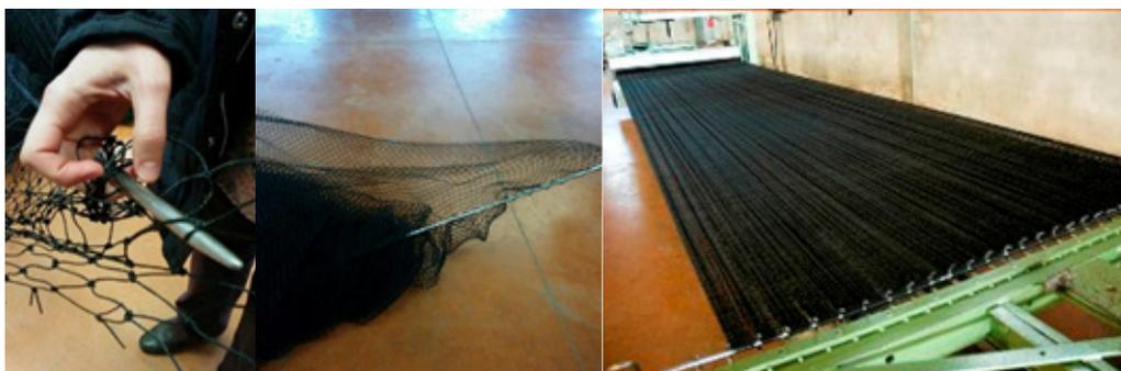
Figura 44 Colocação da rede no estirador. Figura C: Cruz&Cruz.
