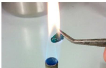
Figura 50 Comportamento após extinção à chama, amostra C.
