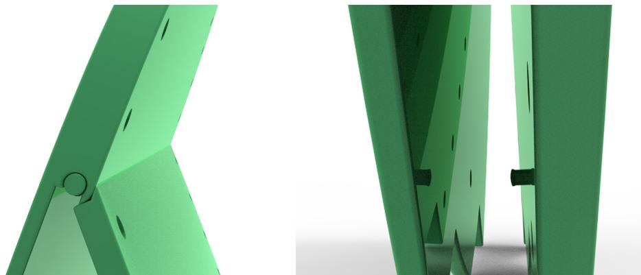
Figura 99 Pormenores do encosto: sistema de encaixe entre o encosto e o apoio e pino que mantém o apoio fechado quando não está a ser utilizado.
