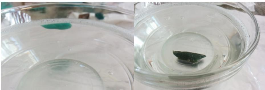
Figura 48 Comportamento em imersão em água, amostra A, B.
