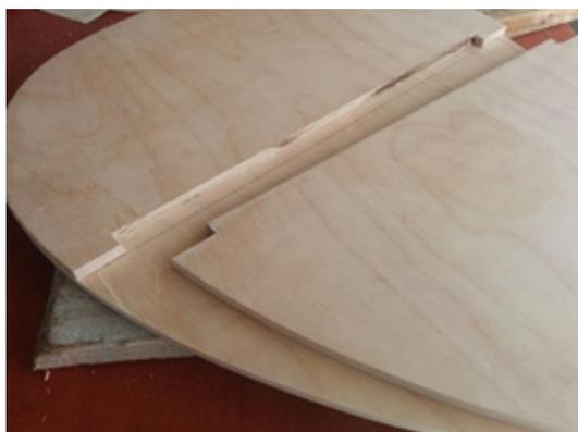
Figura 92 Encosto e apoio em contraplacado.
