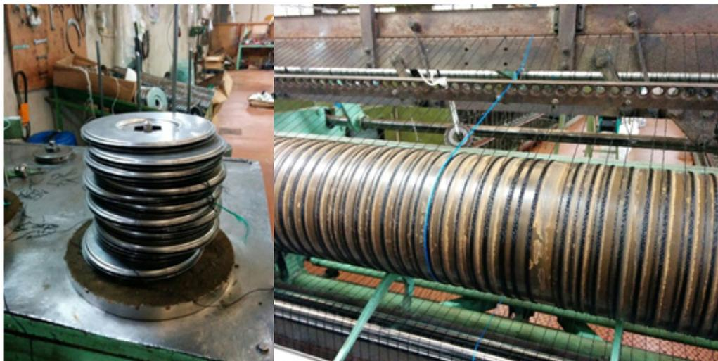
Figura 43 Colocação do fio nas navetas e tecelagem da rede.
