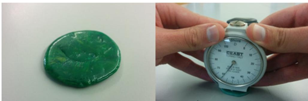
Figura 51 Realização do ensaio de dureza Shore D.
