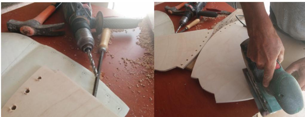
Figura 93 Perfuração das duas placas e polimento das superfícies com uma lixa para madeiras.
