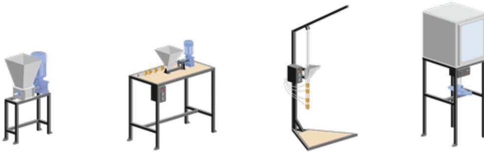
Figura 10 Da esquerda para a direita: extrusora, injetora, compressora e trituradora (Hakkens).
