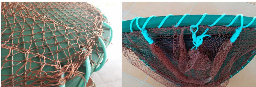
Figura 95 Pormenor da união do saco ao encosto, alças e sistema de fecho do saco.
