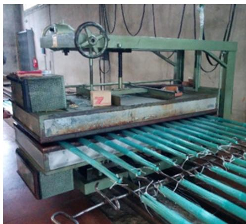
Figura 40 Forno para manter a forma das redes.
