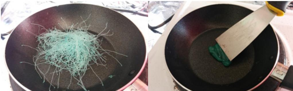
Figura 47 Processo de amolecimento da corda azul – amostra A.
