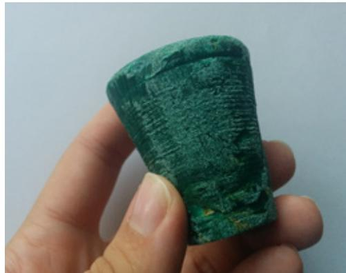
Figura 70 Copo após ser lixado e retirado o excesso de material.
