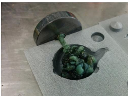
Figura 64 Experiência nº7. Verifica-se a passagem do material para o interior do molde.
