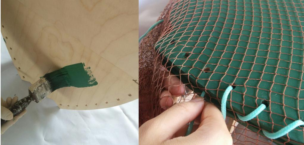
Figura 94 Pintura e colocação do primeiro pedaço de rede no encosto.
