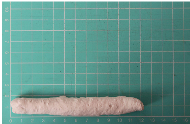
Figura 99 - Filamento Teste de extrudability com 35% areia de betão
