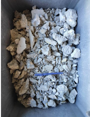
Figura 95 - Cacos de betão, quebrados com um martelo
