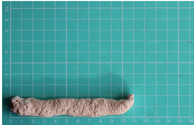
Figura 104 - Filamento Teste de extrudability com 50% areia de tijolo
