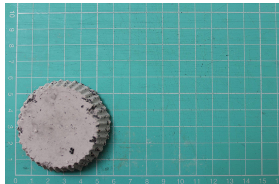
Figura 75 - Teste de amostra com carvão de granulometria 3-4 mm – parte de baixo
