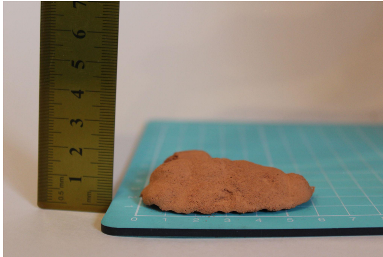
Figura 94 - Filamento Teste de buildability com 100% de tijolo de granulometria < 1 mm
