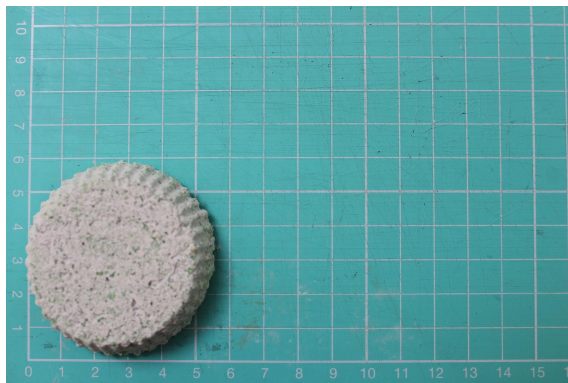
Figura 42 - Teste de amostra com vidro verde de granulometria < 3 mm – parte de cima
