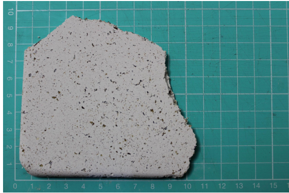
Figura 20 - Teste de amostra com vidro âmbar, areia e cimento branco – parte de cima
