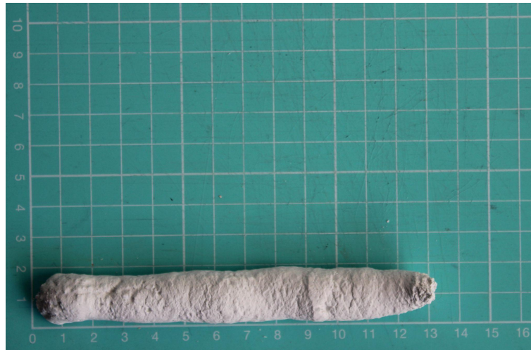
Figura 110 - Filamento Teste de extrudability com 40% areia de vidro
