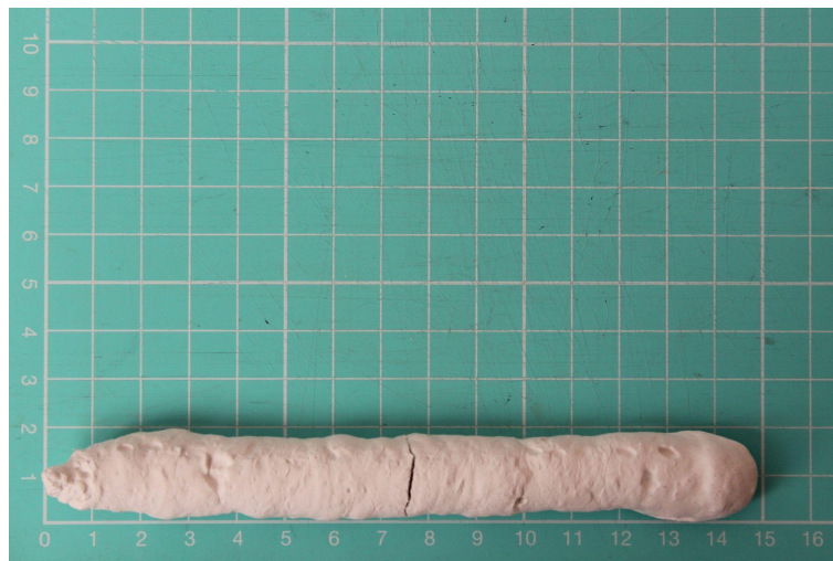
Figura 100 - Filamento Teste de extrudability com 25% areia de betão
