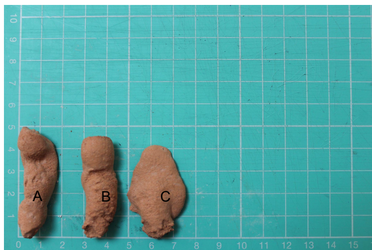
Figura 82 - Filamento Teste de extrudability com redução de cimento, 85% de tijolo de granulometria < 1 mm
