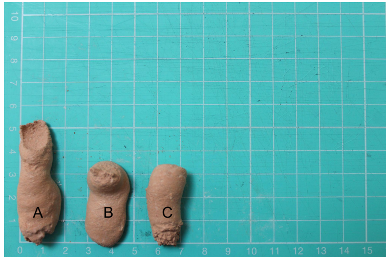
Figura 81 - Filamento Teste de extrudability com redução de cimento, 67% de tijolo de granulometria < 1 mm
