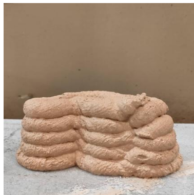
Figura 143 - Peça acabada de imprimir
