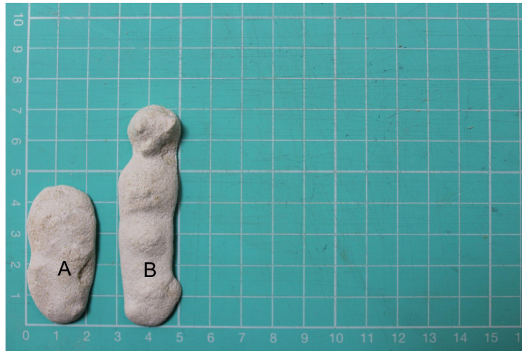
Figura 88 - Filamento Teste de extrudability com redução de cimento com 85% vidro de granulometria < 1 mm
