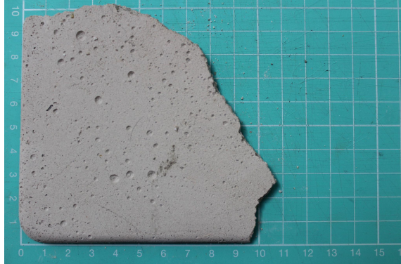
Figura 18 - Teste de amostra com vidro âmbar, areia, cimento branco e cal hidráulica – parte de cima
