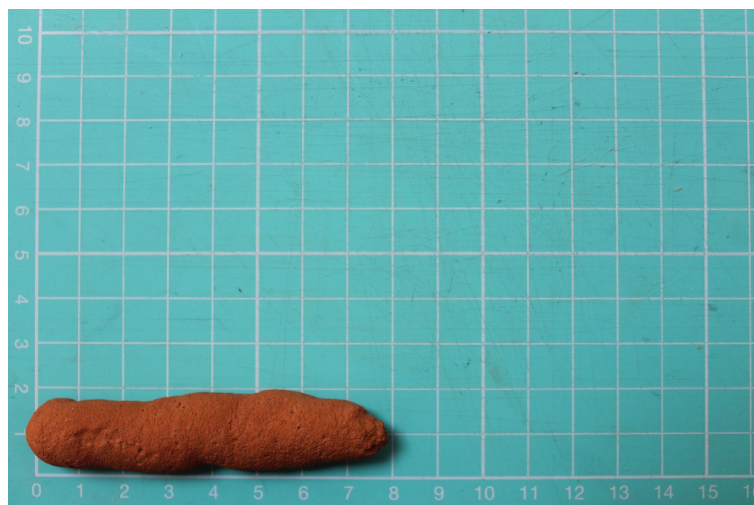
Figura 84 - Filamento Teste de extrudability com redução de cimento, 95% de tijolo de granulometria < 1 mm
