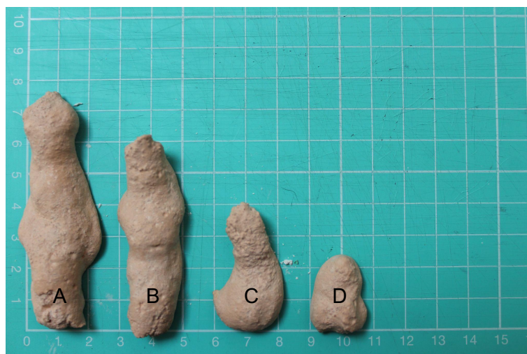
Figura 59 - Filamento Teste de extrusão com tijolo de granulometria < 1 mm
