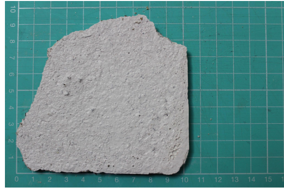
Figura 21 - Teste de amostra com vidro âmbar, areia e cimento branco – parte de baixo
