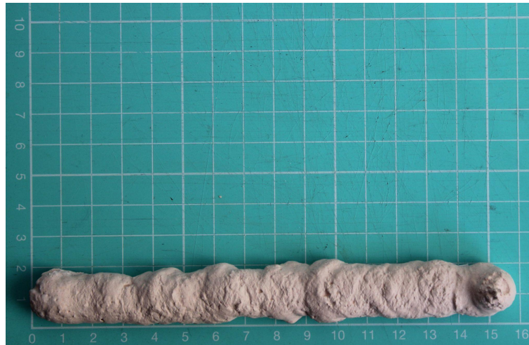
Figura 106 - Filamento Teste de extrudability com 35% areia de tijolo
