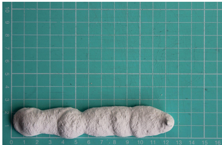
Figura 109 - Filamento Teste de extrudability com 50% areia de vidro
