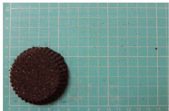
Figura 71 - Teste de amostra com cortiça negra de granulometria < 1 mm – parte de baixo
