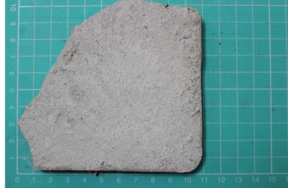
Figura 19 - Teste de amostra com vidro âmbar, areia, cimento branco e cal hidráulica – parte de baixo
