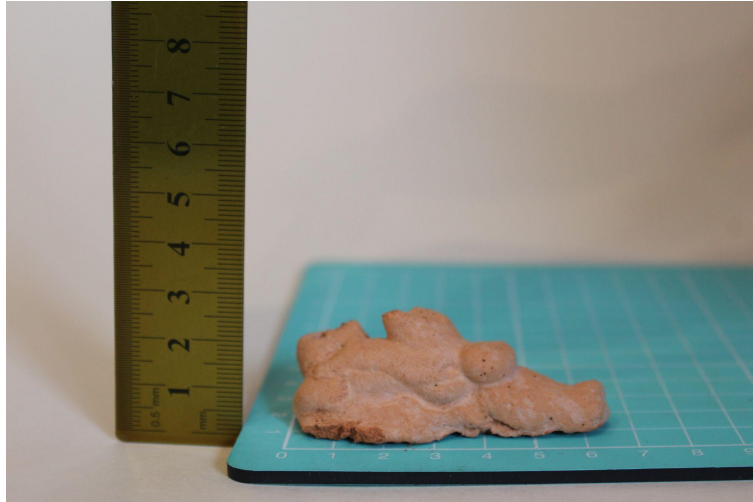
Figura 93 - Filamento Teste de buildability com redução de cimento, 95% de tijolo de granulometria < 1 mm
