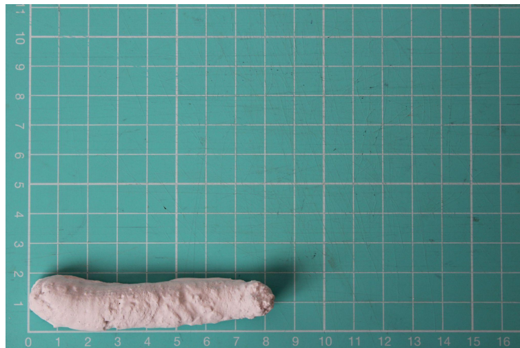
Figura 98 - Filamento Teste de extrudability com 40% areia de betão
