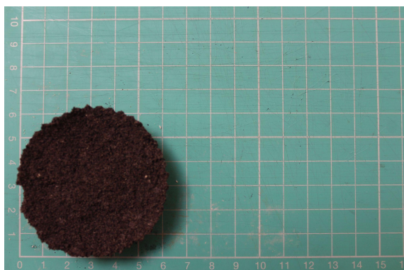
Figura 70 - Teste de amostra com cortiça negra de granulometria < 1 mm – parte de cima
