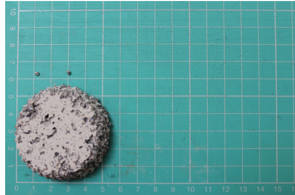
Figura 67 - Teste de amostra com material (aglomerado de pneu, plástico e cortiça) de granulometria < 4 mm – parte de baixo
