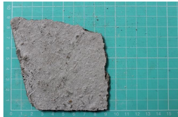
Figura 17 - Teste de amostra com vidro âmbar, cimento cinza e areia - parte de baixo
