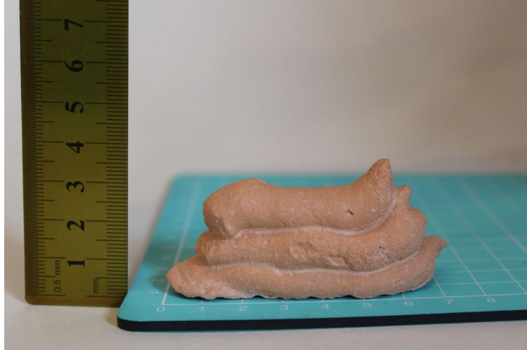
Figura 91 - Filamento Teste de buildability com redução de cimento, 85% de tijolo de granulometria < 1 mm
