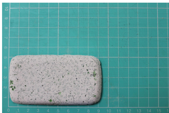
Figura 26 - Teste de amostra com vidro verde de granulometria 3-4 mm – parte de cima
