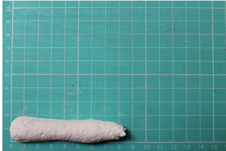
Figura 65 - Filamento Teste de extrusão com tijolo de granulometria 3-4 mm
