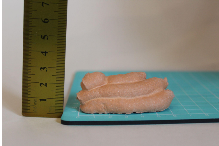
Figura 90 - Filamento Teste de buildability com redução de cimento, 75% de tijolo de granulometria < 1 mm
