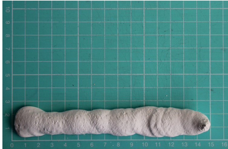
Figura 111 - Filamento Teste de extrudability com 35% areia de vidro
