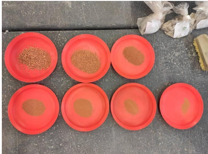
Figura 115 - Distribuição de granulometrias, de cima-esquerda para baixo-direita: 4 mm; 1 mm; 0,50 mm; 0,250 mm; 0,125 mm; 0,063 mm; <0,063 mm
