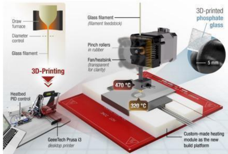
Figura 6 - Impressão 3D por extrusão de vidro fosfatado
