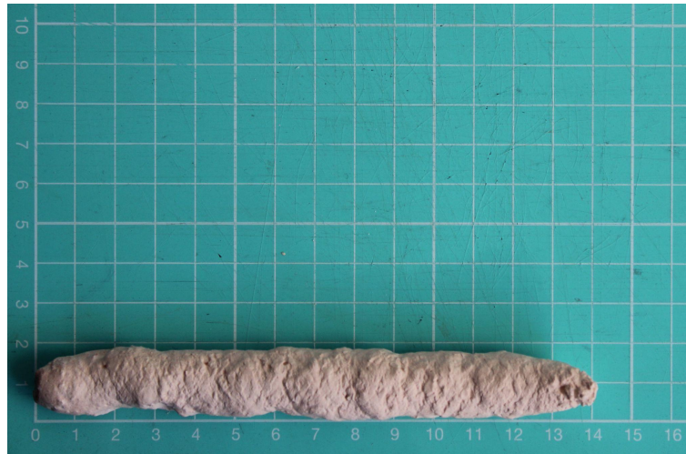
Figura 105 - Filamento Teste de extrudability com 40% areia de tijolo
