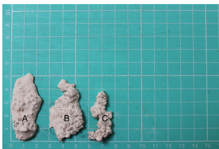
Figura 86 - Filamento Teste de extrudability com redução de cimento, 67% de tijolo de granulometria 3-4 mm
